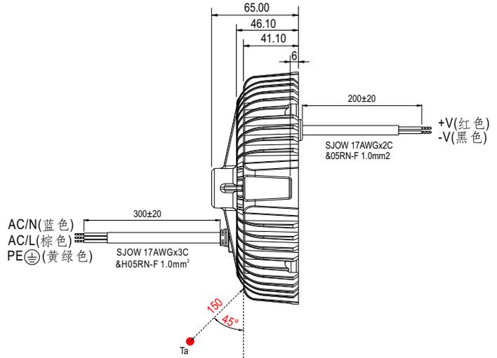
※ **AB型**(带固定电缆的AC输入线)
