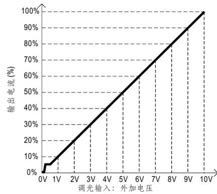
◎ 用外加10V PWM信号(频率范围:100Hz~3KHz):
