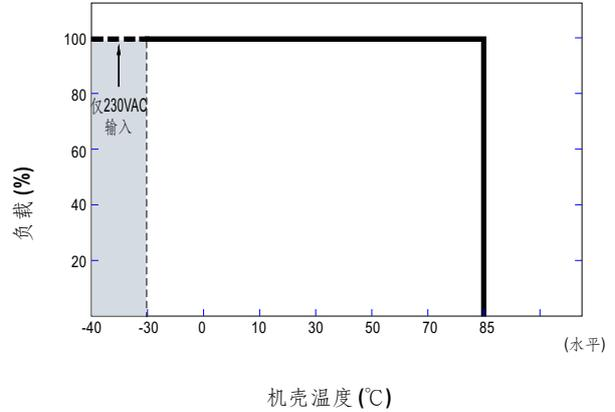
备注：在-30°C满载时和工作在输入电压为100VAC，电源可能会出现软启动。
