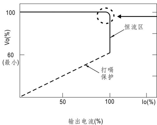
在恒流区,驱动器的最高输出电压取决于终端系统的配置。
