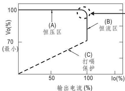
在恒流区, 驱动器的最高输出电压取决于终端系统的配置
