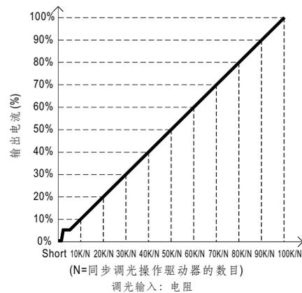
注意: 1. 最小的调光比例在8%左右, 当输出电流在0%<I<sub>out</sub><8%, 输出电流精度不做定义。
