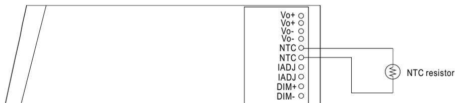
◎ NTC感应器在空接没有使用时，LDC-35仍可正常工作，输出电流则依您所选择的电流档位的电流值输出
