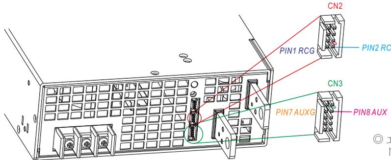
◎ 工厂默认设置为CN2上的PV(PIN3)和PS(PIN4)短接; 同样, CN3上的OLP(PIN9)和OL-SD(PIN10)也短接。
