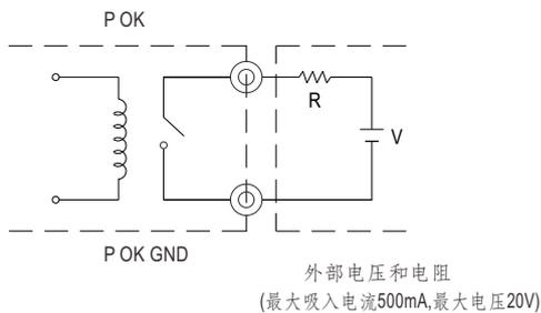
图4.1电源正常的内部回路(继电器,共10W)
