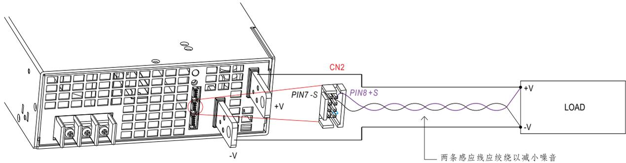
※ 注意:电源出厂默认设置为CN2上的-S & -V短接, +S & +V也一样。当遥感功能被激活, +S要连接负载的正极, -S要连接负载的负极。
