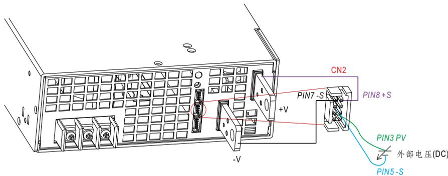
◎ 在CN2的PV和-S间连接一外部直流电压, 并且+S & +V, -S & -V 同样需要按上图所示连接
