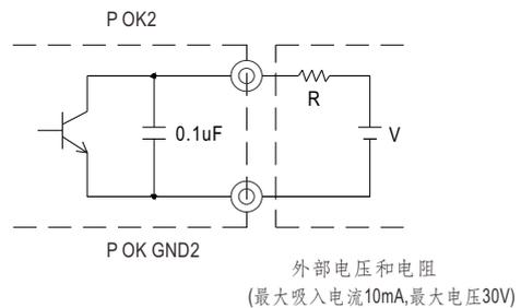
图4.2电源正常的内部回路(集电极开路的方法)
